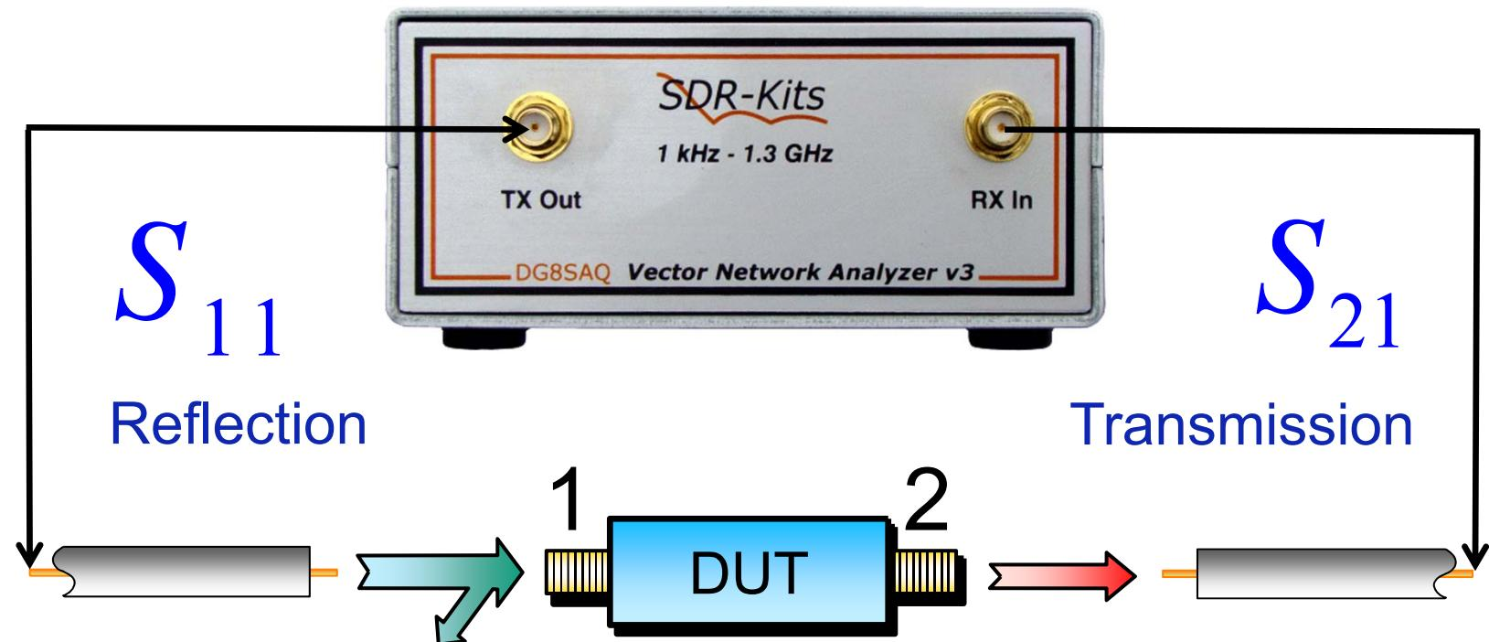
DUT : DEVICE UNDER TEST
